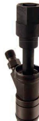
Fixe o lado roscado M17 do fuso no rosca fêmea do injetor aplicando uma força de Aproximadamente 5Nm.
