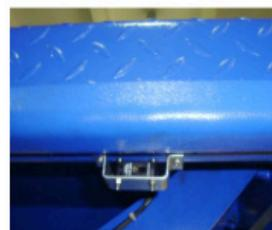
Figura 24 (posição do sensor fotocélula)
