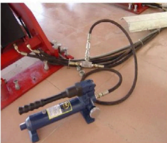
Figura 34 (bomba manual por conta do operador )
